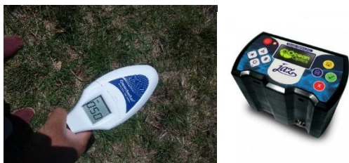
Figura2. Instrumentos de medición GreenSeeker. Espectrómetro óptico “JAZ”
