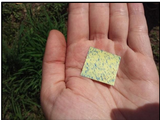
Figura n° 22: Control de la deriva y velocidad de aplicación con tarjetas hidrosensibles..
