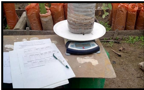
Figura 13: Procedimiento de pesado de sustrato para determinación de densidad.
