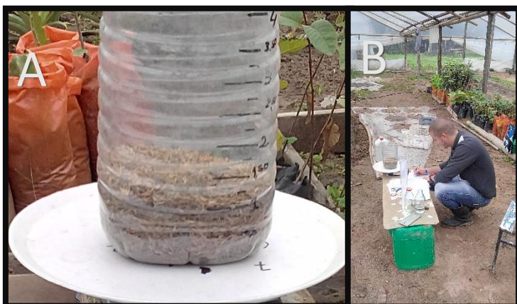
Figura 14: Mediciones de volumen de sólidos y de poros A) Cilindro graduado. B) pesado y toma de valores.
