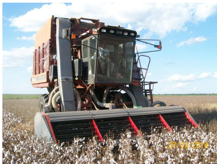
Foto 15: Cosechadora stripper modificada por la Empresa Argento con sistema de prelimpieza.
