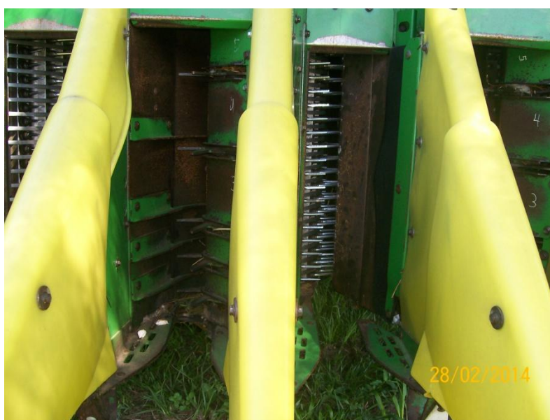
Foto 13: Detalle de husillos y cuchillas para cortar plantas del liño adyacente en algodón surco estrecho.
