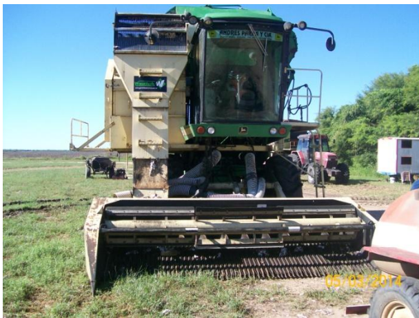
Foto 14: Cosechadora stripper autopropulsada modificada por la Empresa WOUCHUK.
