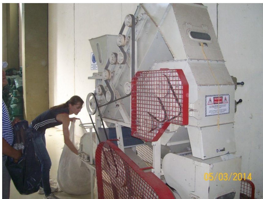
Foto 19: Desmote de muestras de algodón con desmotadora “Baby”.
