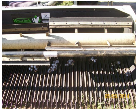
Foto 14: Cosechadora stripper autopropulsada modificada por la Empresa WOUCHUK.
