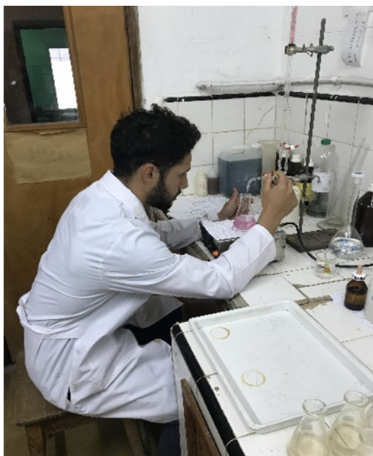
Figura n° 2: Determinación de materia orgánica por titulación con el método de Walkey-Black modificado (Nelson & Sommers, 1996).
