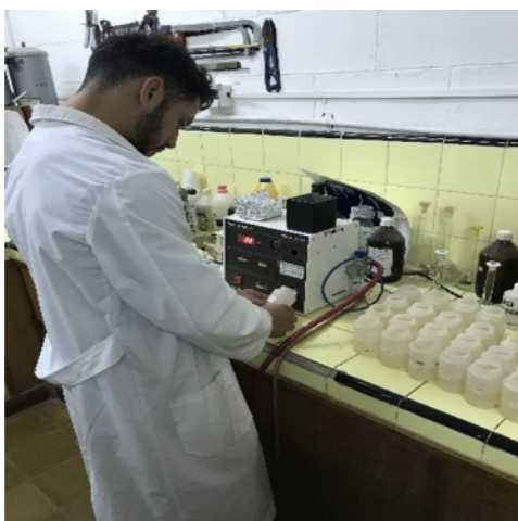
Figura n° 4: Determinación de potasio intercambiable con fotómetro de llama
