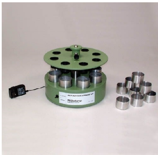
Figura n° 3: Maquina para realizar estabilidad de agregados con tamizado en húmedo según el método de Kemper & Rosenau, 1986.
