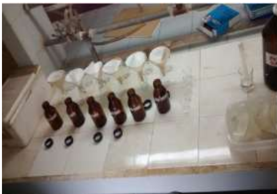
Figura 08: Filtrado de muestras post incubación.
