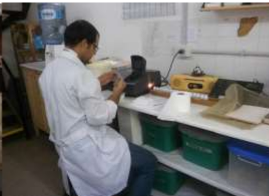
Figura 09: Lectura del p-nitrofenol liberado usando un fotocolorímetro calibrado a 410nm.
