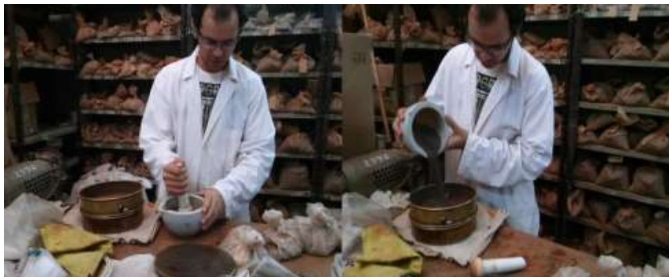
Figura 05: proceso de molido del suelo con mortero y pistilo.
