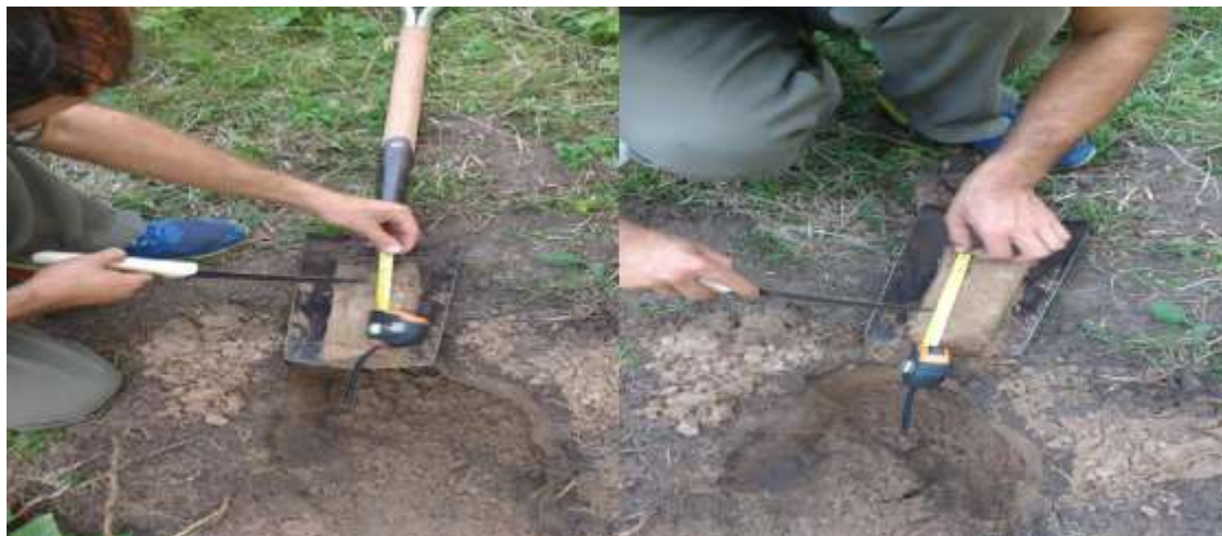
Figura 01: muestreo de suelo a la primer profundidad (0-7 cm).
