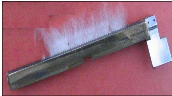
Figura 57. Grampa de sujeción de fibra para determinar longitud.
