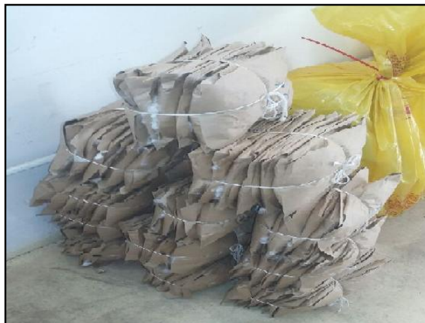
Figura 52. Muestras preparadas para ser analizadas con H.V.I.
