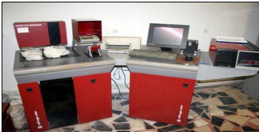
Figura 56. Instrumento de Precisión de alto Volumen “H.V.I.”
