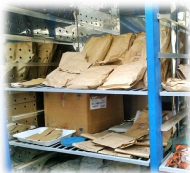
Figura 9: Muestras desecándose en estufa.
