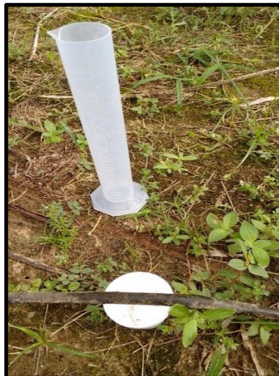
Figura 2: Medición del caudal arrojado por el sistema de riego aplicado al cultivo de Mamón.
