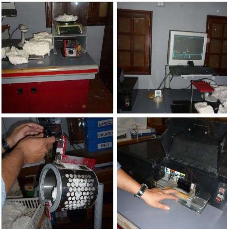
Figura 15: Varios módulos o elementos del "HVI" que analizan las muestras de fibra.
