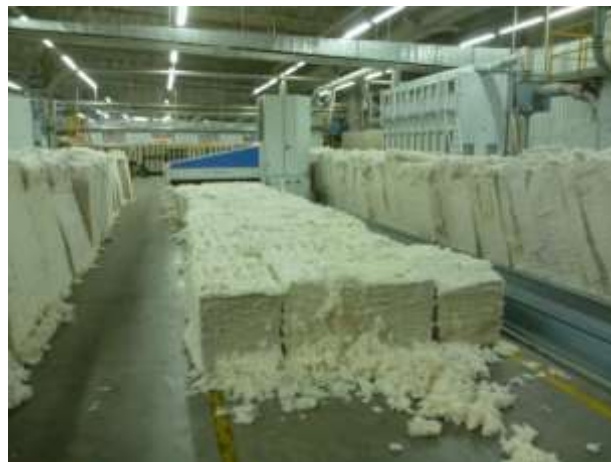
Figura 16: Apertura de fardos, primera etapa en el proceso de hilatura de fibra de algodón.
