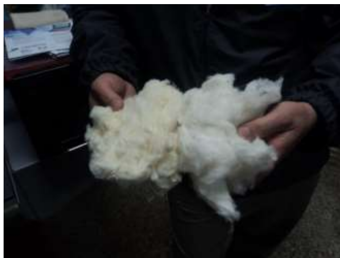
Figura 32: Comparación de dos muestras de fibras de distinto color, a la izquierda la fibra de color blanco amarillento y a la derecha la fibra de color blanco brillante.
