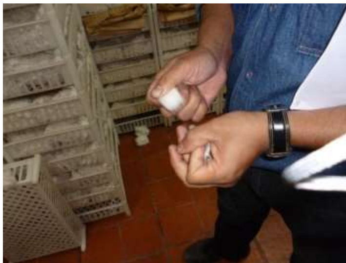
Figura 11: Clasificador demostrando como se realiza el "peinado" de fibras para clasificarla dentro de un grado comercial.
