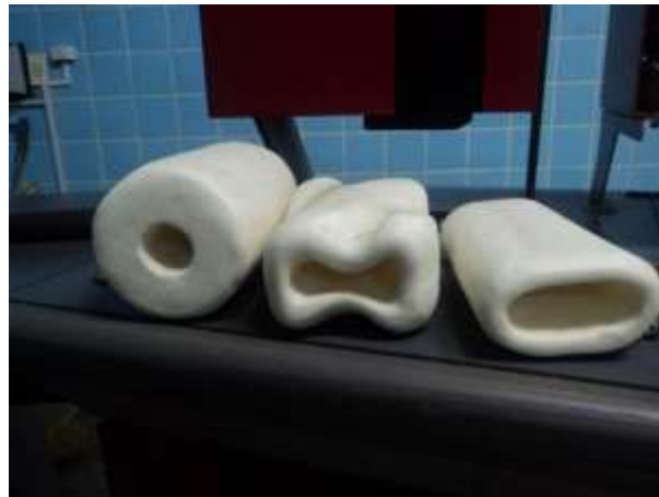
Figura 28: Representación de los diferentes grados de micronaire o grosor, siendo la figura de la derecha de escaso grosor, la de la izquierda con excesivo grosor y la del medio de grosor óptimo.
