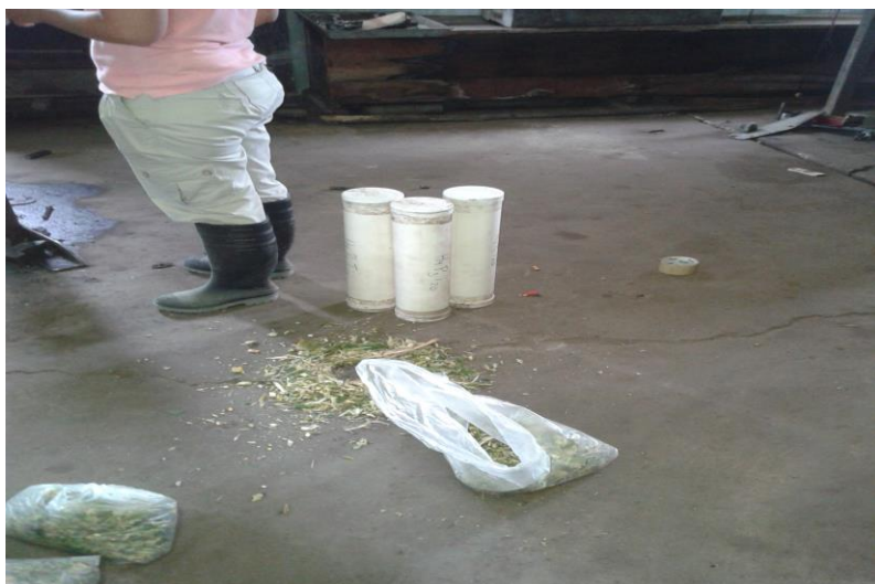
Figura 5: Tubos de PVC de 50cm de largo y 10cm de diámetro para la confección de microsilos.
