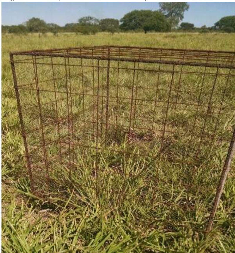
Fig. 14: Jaula de exclusión, tamaño de 1m x 1m x1m.
