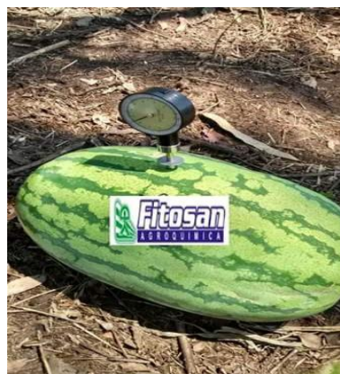
Figura 14: Determinación de firmeza de corteza
