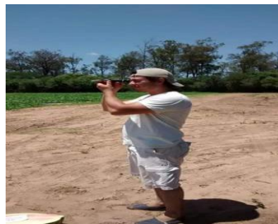
Figura 12: Determinación de °Brix
