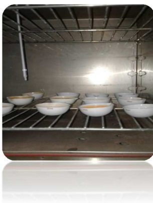
Fig. 5 Estufa abierta con material en capsulas de porcelana
