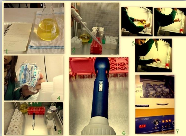
FIGURA 14: Preparación del Material Inoculante: 1) Medio de cultivo líquido listo para uso; 2) y 5) Detalle de elementos empleados; 3) Incorporación del nuevo medio a los vasos estériles y traspaso de aislamientos conservados en tubos a los mismos; 4) Detalle del paquete de vasos estériles; 6) Calibrado de pipeta; 7) Vasos estériles en equipo shaker a 29,5°C.
