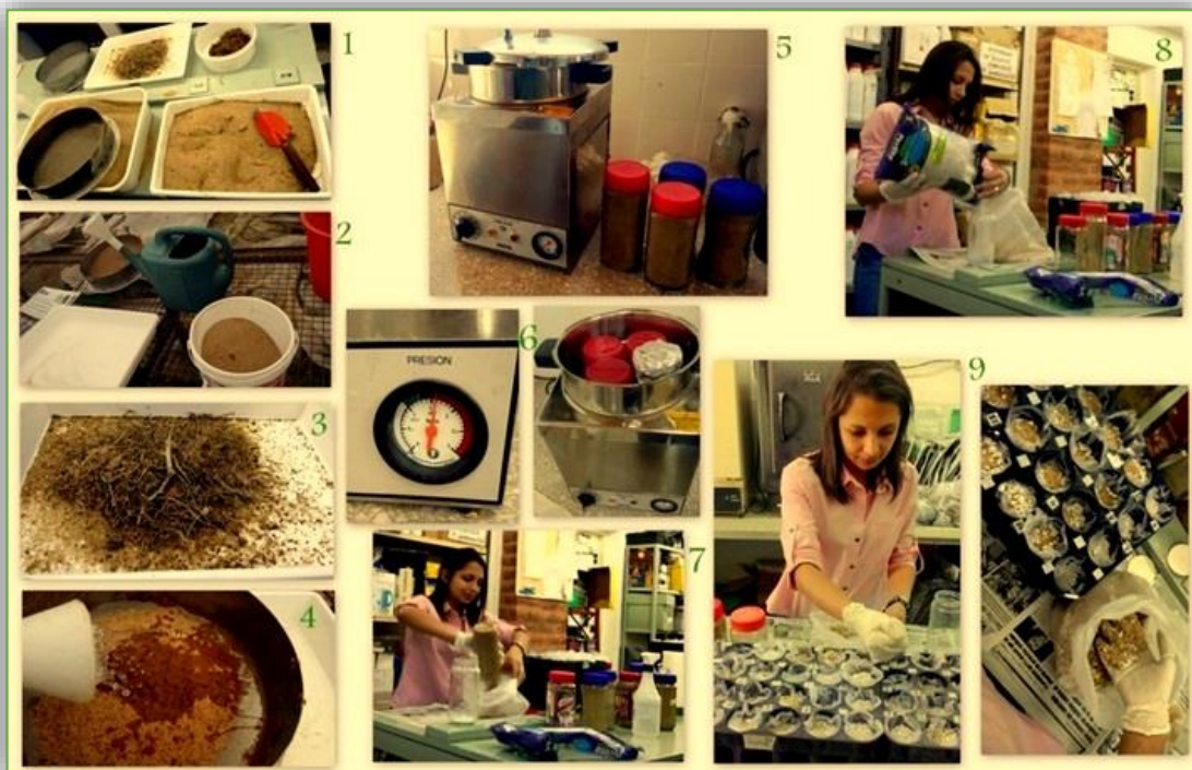
FIGURA 16: Preparación del Sustrato: 1) Tamizado de arena de río; 2) Elementos para lavado de la arena; 3) Residuos del tamiz; 4) Lavado de arena; 5) y 6) Frascos con arena seca, lavada y tamizada para esterilizar con detalle de autoclave en funcionamiento; 7) y 8) Mezclas 1:1 de arena y perlita; 9) Detalle del sustrato terminado e incorporación en bandejas.
