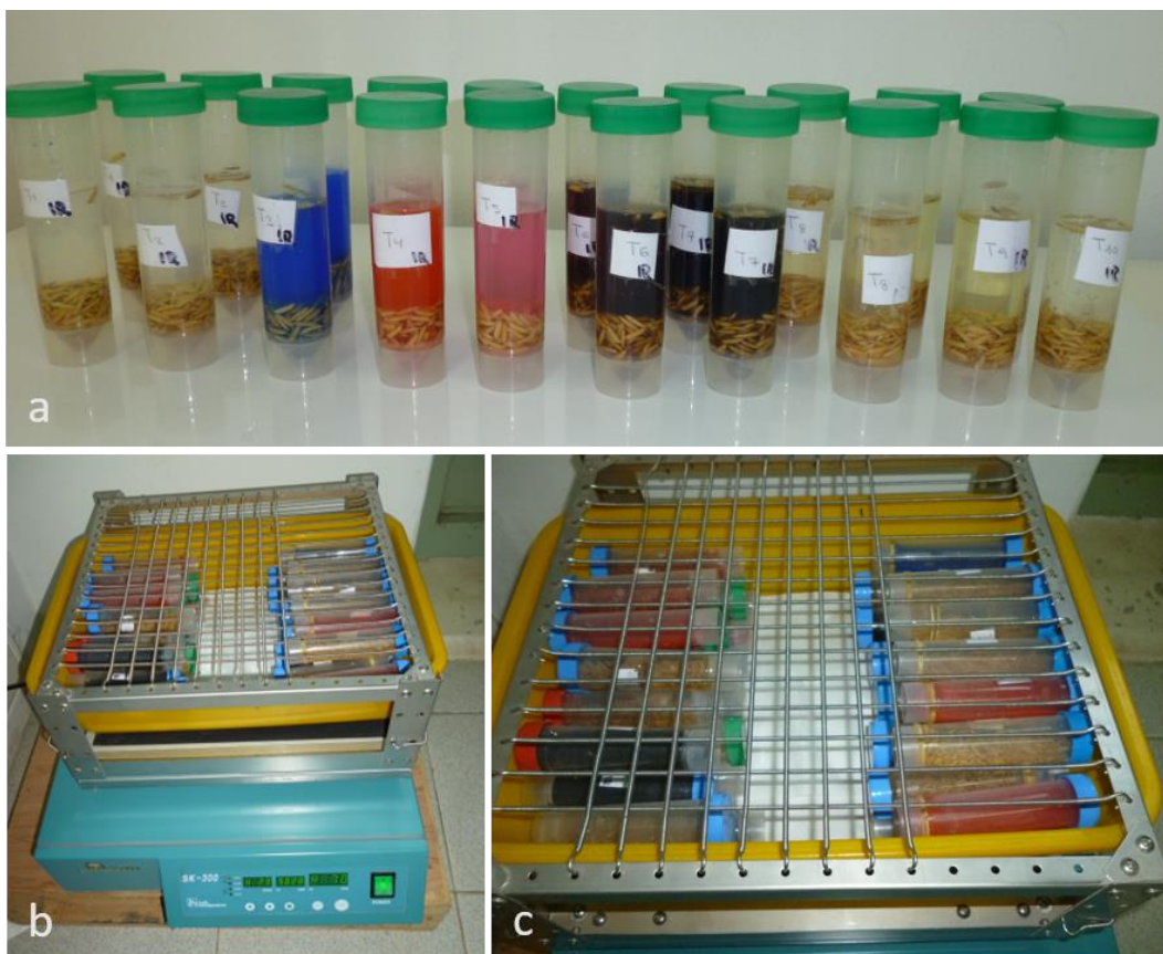
Fig. 11. Priming en semillas de arroz: a) semillas en tubos falco preparadas para el avance fisiológico; b y c) Tubos falco acomodados en agitador de vaivén seteado a 70 rpm. Pasadas las 24 horas se enjuagaron las semillas de cada tratamiento con agua de red (figura 12) y se dejaron secar a temperatura ambiente (figura 13 a y b) controlando su peso periódicamente hasta alcanzar peso constante.
