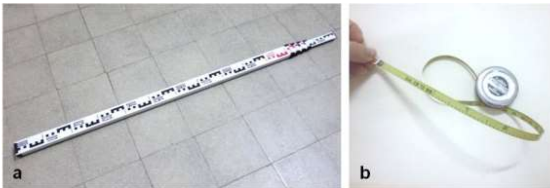
Fig. 3. a) Mira telescópica de aluminio empleada para la medición de alturas; b) Cinta diamétrica usada para medición de diámetros.
