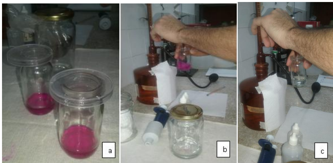
Figura 5. Titulación de las muestras a-Separación de una alícuota del NaOH del frasco y aplicación de la fenolftaleína; b-titulación con el HCl; c-viraje de rosado-fucsia a incoloro
