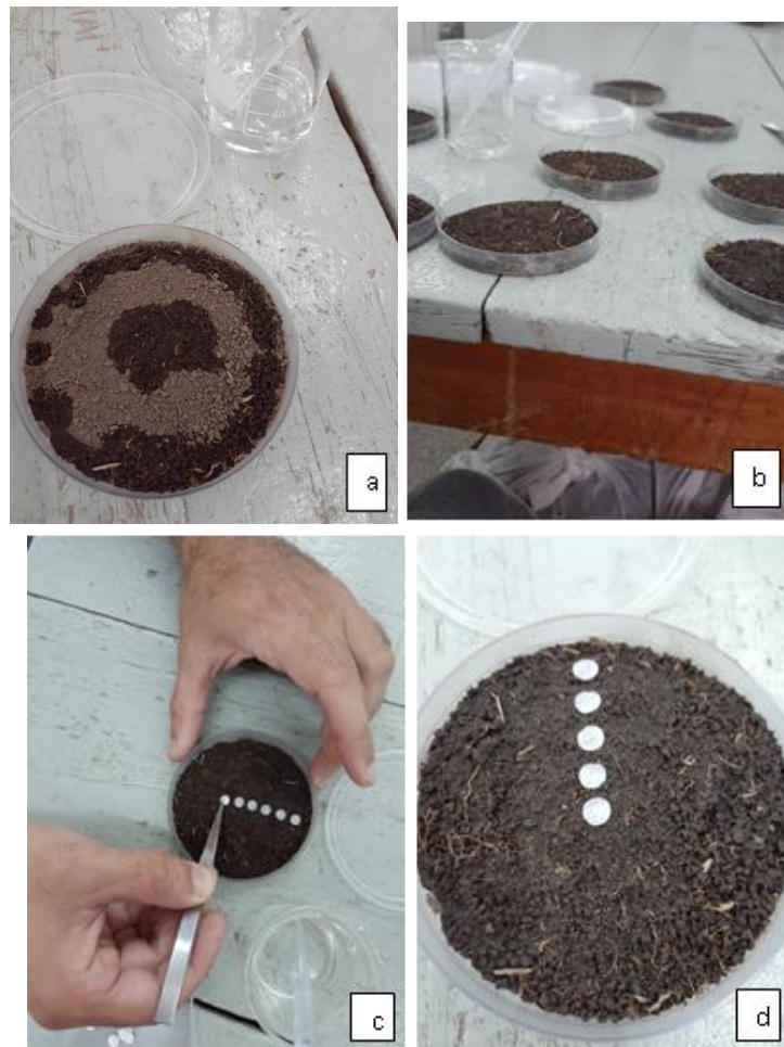
Figura 12. Preparación para la determinación de la actividad celulolítica. a- Humedecimiento del suelo; b-placas con suelo húmedo listas para colocar la fuente de celulosa; c y d- colocación de los microdiscos de papel
