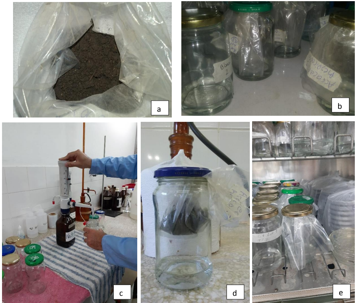
Figura 3. Preparación de la determinación de actividad biológica global. a-muestra de suelo humedecida; b-muestras de suelos en los frascos con NaOH y se puede ver además el blanco con frasco sin muestra de suelo; c-llenado de los frascos con NaOH; d-muestra del frasco con suelo e hidróxido; e-Incubación de los frascos en estufa.
