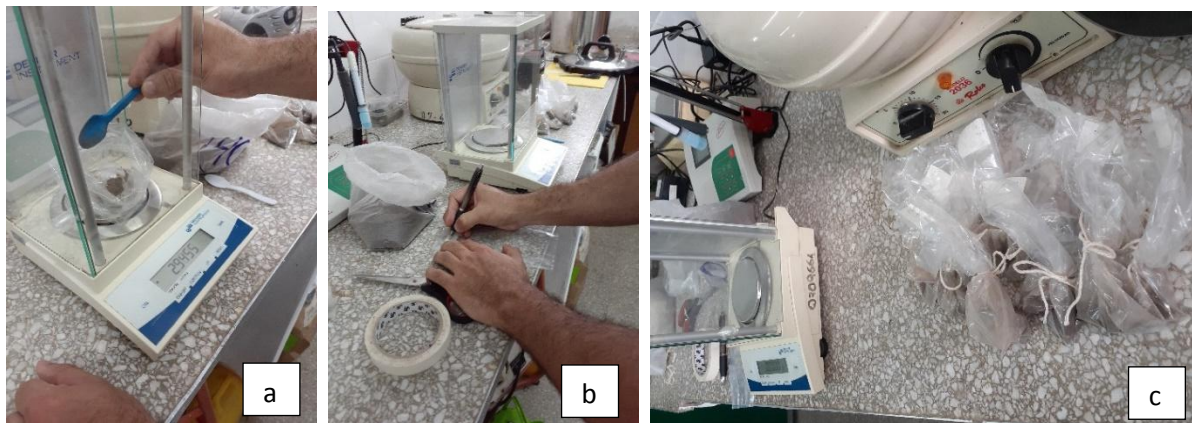
Figura 2. Fraccionamiento de las muestras para las posteriores determinaciones. a- pesado de las muestras en balanza digital de precisión; b-etiquetado de las bolsas de fraccionamiento; c-muestras fraccionadas para las determinaciones
