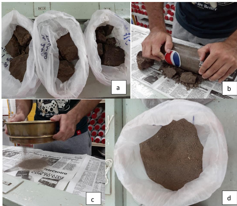
Figura 1. Tareas en el acondicionamiento de las muestras a-secado al aire de las muestras; b-molido del suelo; c- tamizado del suelo; d-muestra tamizada en bolsa para ser guardada.
