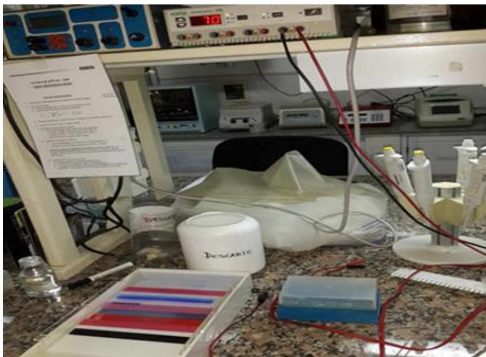
Figura 19. Electroforesis en gel de agarosa mediante cuba electroforética a 50 V. Para análisis de calidad y cuantificación de ADN genómico obtenido.
