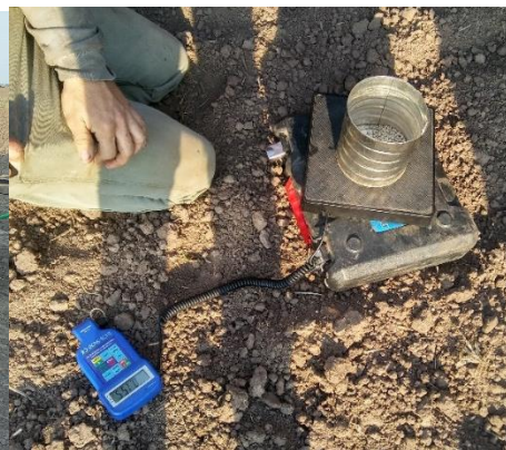
Foto n° 8: Balanza utilizada para regular el cuerpo fertilizador
