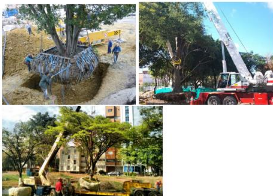
Figura 5. Máquinas adaptadas para trasplante de ejemplares adultos. Extraído de https://www.google.com.ar/search?q=maquinas+de+trasplantes+de+arboles&safe=off&espv=2&biw=1280&bih=655&source=lnms&tbm=isch&sa=X&ved=0ahUKEwiT5bvR_pfMAhVCEpAKHUB-B5MQ_AUIBygB
