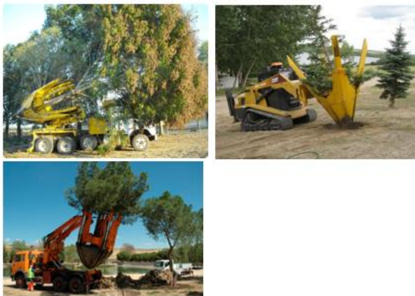
Figura 4. Ejemplos de maquinarias especializadas para trasplante de ejemplares adultos. Extraído de https://www.google.com.ar/search?q=maquinas+de+trasplantes+de+arboles&safe=off&espv=2&biw=1280&bih=655&source=lnms&tbm=isch&sa=X&ved=0ahUKEwiT5bvR_pfMAhVCEpAKHUB-B5MQ_AUIBygB
