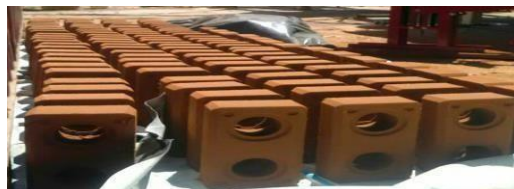
Figura 16: Ladrillos ecológicos de suelo cemento
