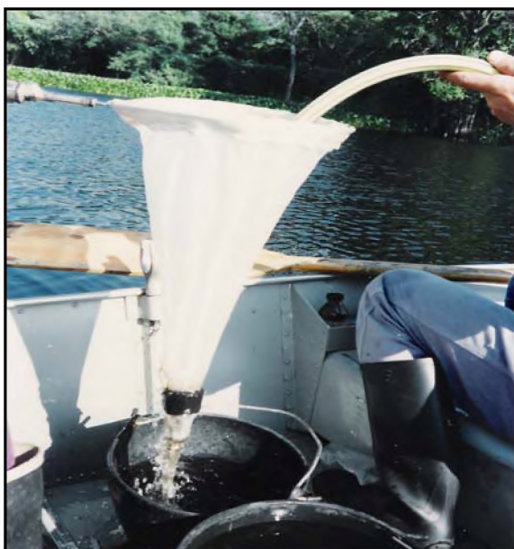
Fig. 3. Filtrado del zooplancton en una red de 53 µm de abertura de malla. El agua sin plancton es medida para conocer el volumen inicial filtrado
