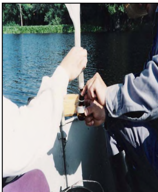
Fig. 4. Concentración de agua con zooplancton en una botella rotulada, luego se fija la muestra con formol
