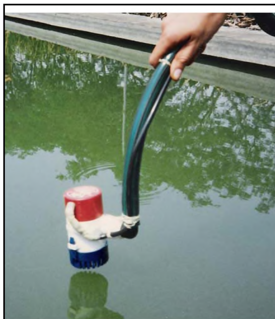
Fig. 2. Bomba usada para tomar muestras cuantitativas de zooplancton
