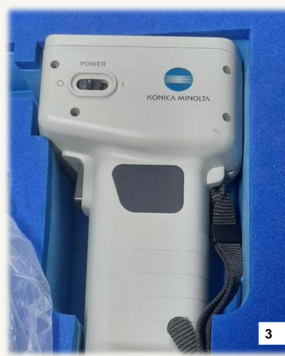
Foto 3: Colorímetro Minolta CR400
