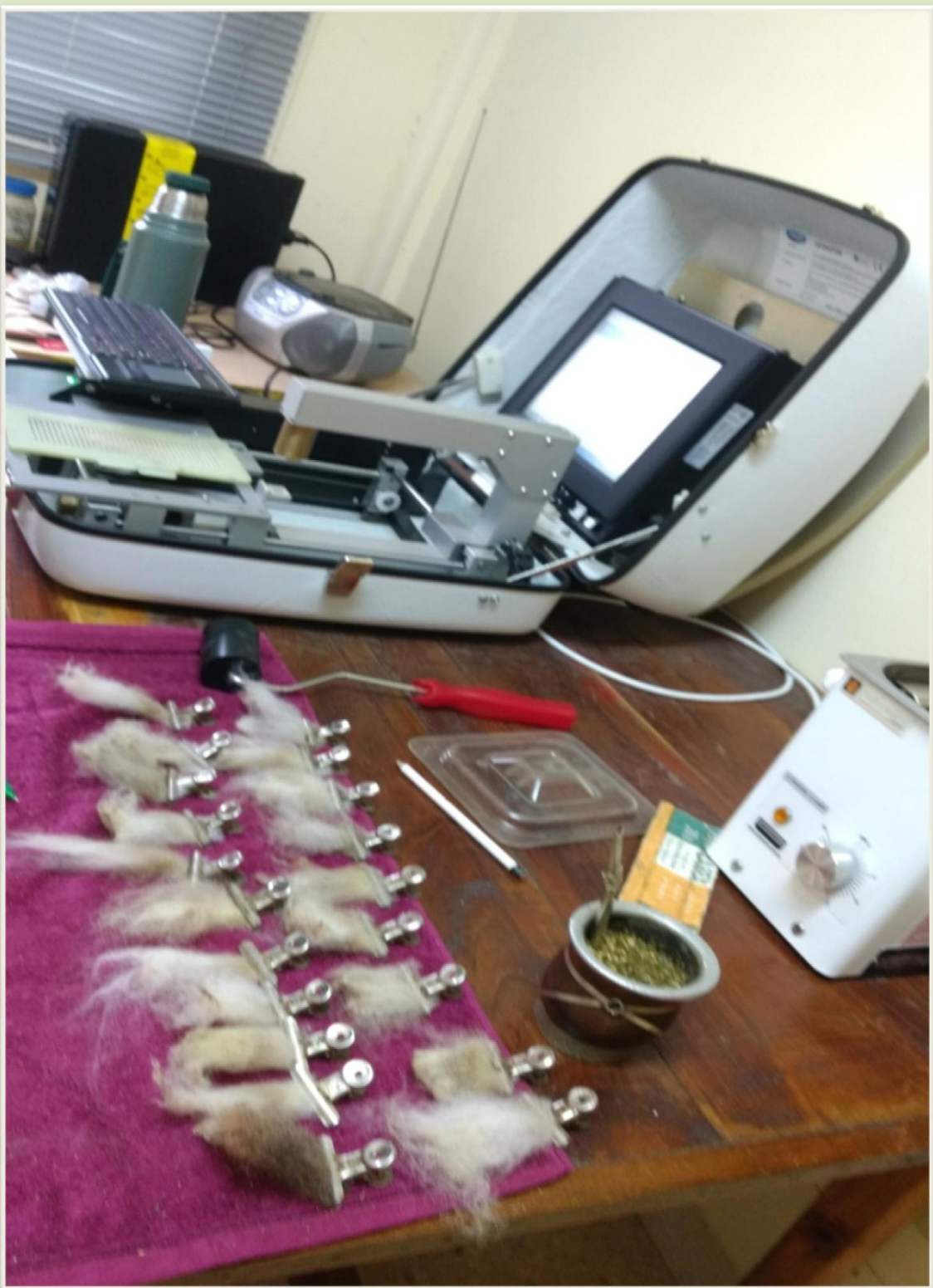
Imagen 2: análisis de muestra por OFDA 2000 ®.
