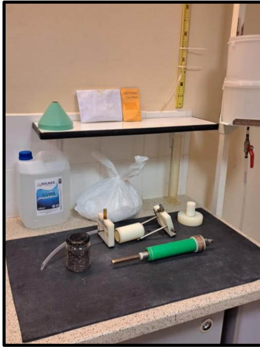
Figura 5.3 Equipamiento utilizado para ensayo Pinhole (Fuente: Elaboración propia)
