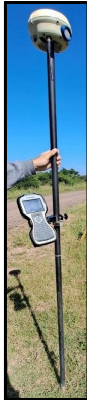
Figura 4.5 Jabalina equipada con la colectora y el receptor móvil (Fuente: Elaboración propia).
