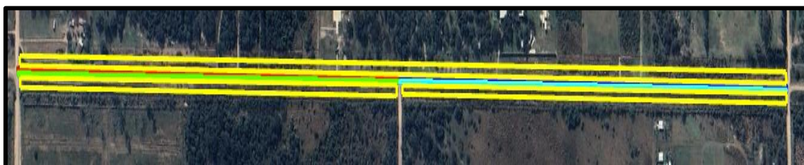
Figura 6.12 Áreas de aporte adicionales remarcadas en amarillo (Fuente: Elaboración propia en base Google Earth).
