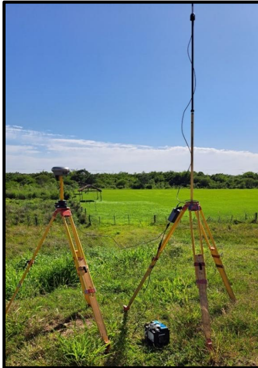
Figura 4.4 Receptor base (izquierda) y antena micro centrada (derecha) (Fuente: Elaboración propia).
