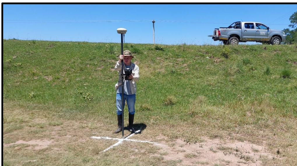
Figura 4.7 Relevando el PAF con GPS (Fuente: Elaboración propia).
