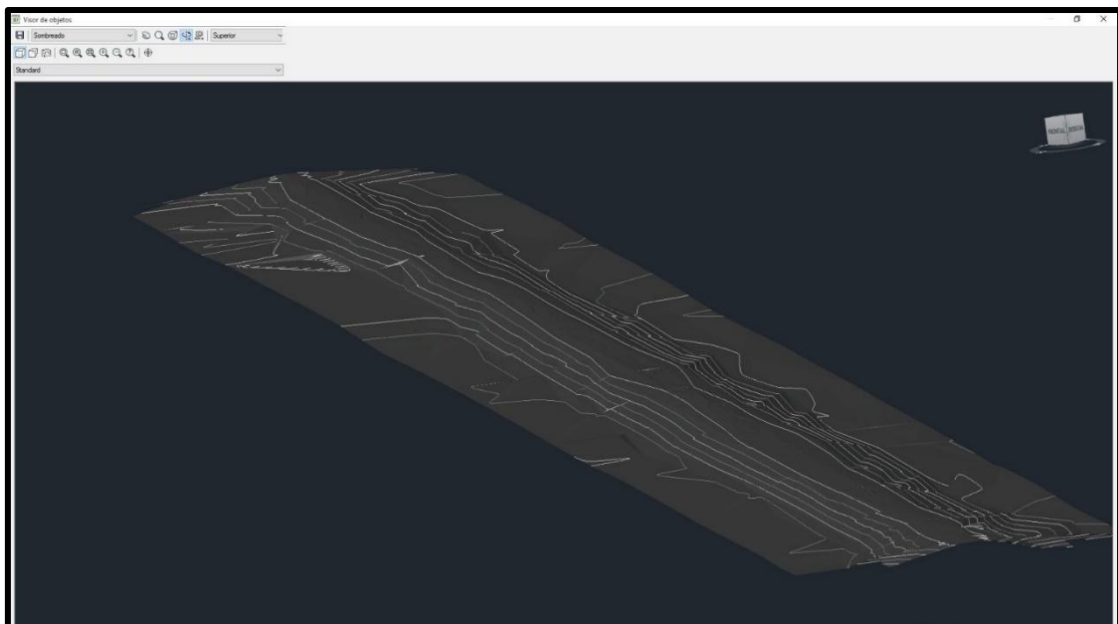
Figura 4.14 Modelado 3D del terrapién (Fuente: Elaboración propia).
