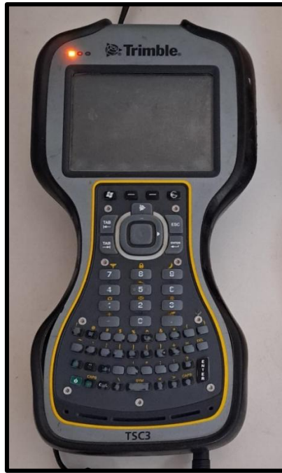
Figura 4.1 Colectora marca Trimble modelo TSC3 (Fuente: Elaboración propia).
