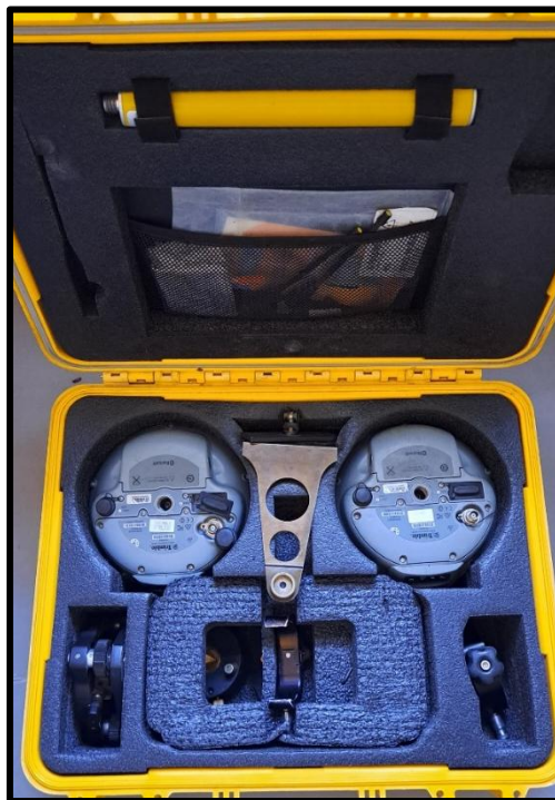
Figura 4.2 Receptor base (izquierda) y receptor (derecha) marca Trimble modelo R8 (Fuente: Elaboración propia).
