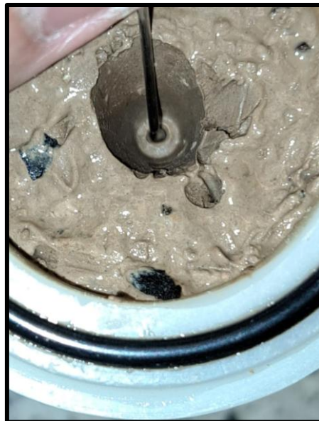
Figura 5.4 Orificio resultante de muestra sin cal agregada. Fuente: Elaboración propia
