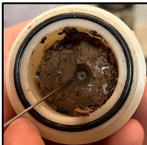
Figura 5.5 Orificio resultante de muestra con 4% cal agregada. Fuente: Elaboración propia
