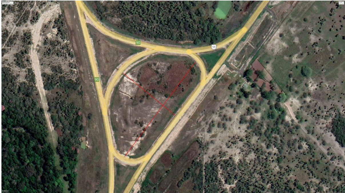
Fotografía 2.107. Radios rotonda RP90-RN11. Radio mayor 300m, radio menor 170m. (Fuente: Google Earth).
