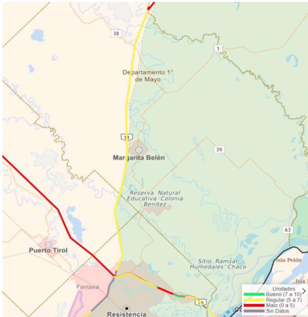
Figura 2.2. Índice de estado del tramo. (Fuente: Sig – Vial).
