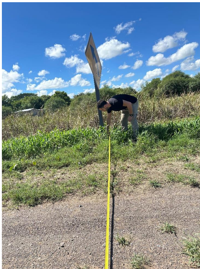
Fotografía 2.88. Distancia adecuada de señales verticales desde calzada (4 metros). (Fuente: Elaboración propia).
