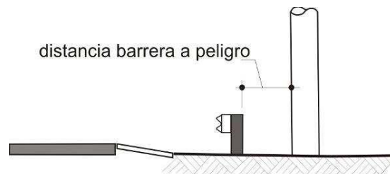
Figura 3.13. Distancia desde barrera a objeto fijo. (Fuente: C7, Norma DNV).
