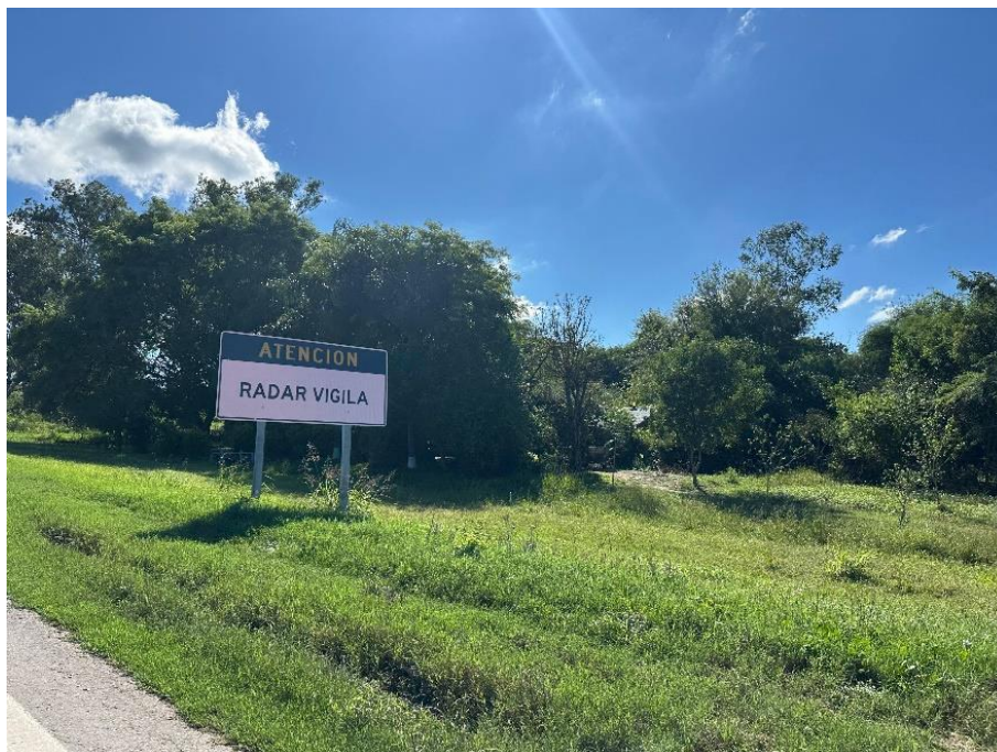
Fotografía 2.96. Señal vertical de presencia de RADAR incorrecta ya que el mismo no está en funcionamiento. (Fuente: Elaboración propia).
