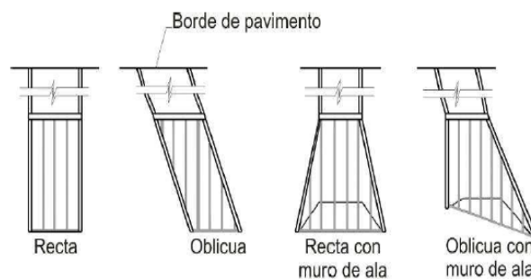
Figura 3.11. Tipos de rejillas para alcantarillas. (Fuente: C7, Norma DNV).
