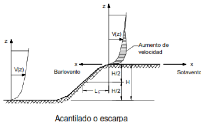
Figura N° 4.2. Longitudes que intervienen en la determinación de K_{zt} . Reglamento CIRSOC 102 julio del 2005 (Figura 2).
