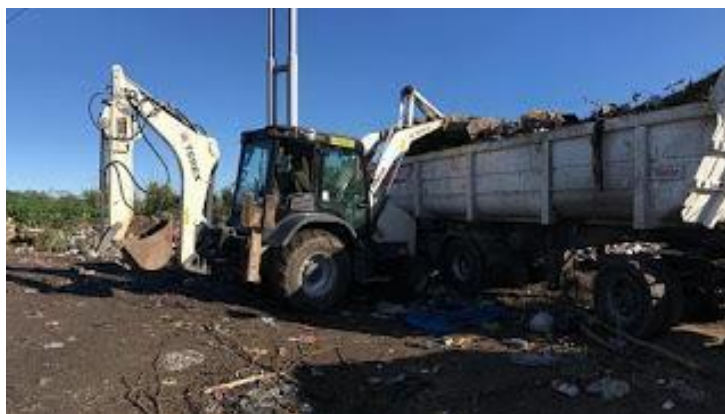
Figura 6.3: imagen ilustrativa de carga de camión batea mediante una retroexcavadora ( http://www.quilmesadiario.com.ar/2020/04/el-municipio-de-quilmes-informo-que-hoy.html ).
