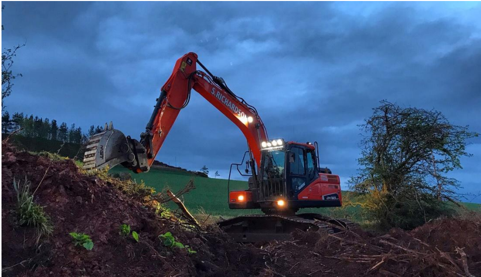
Figura 6.2: Imagen ilustrativa de excavadora con orugas realizando desbosque y destronque ( https://www.interempresas.net/ObrasPublicas/Articulos/262597-Nuevas-excavadoras-de-orugas-elevadas-de-Doosan-para-un-contratista-forestal-escoces.html ).
