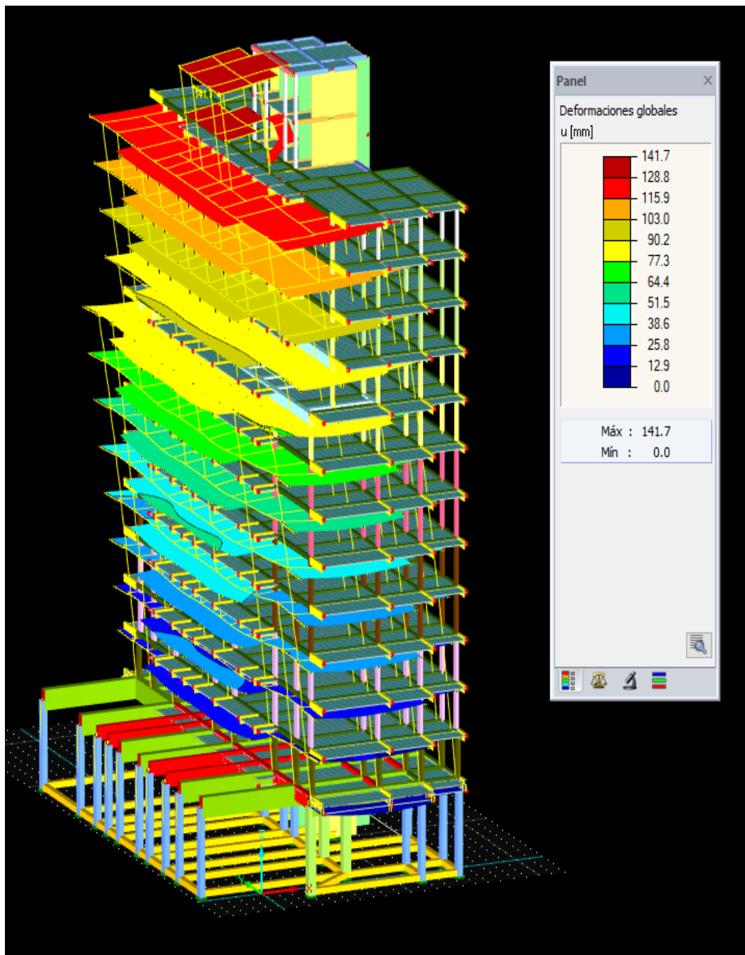
Diseño y calculo estructural: Fig. 12 Esquema estructural, deformaciones globales.
