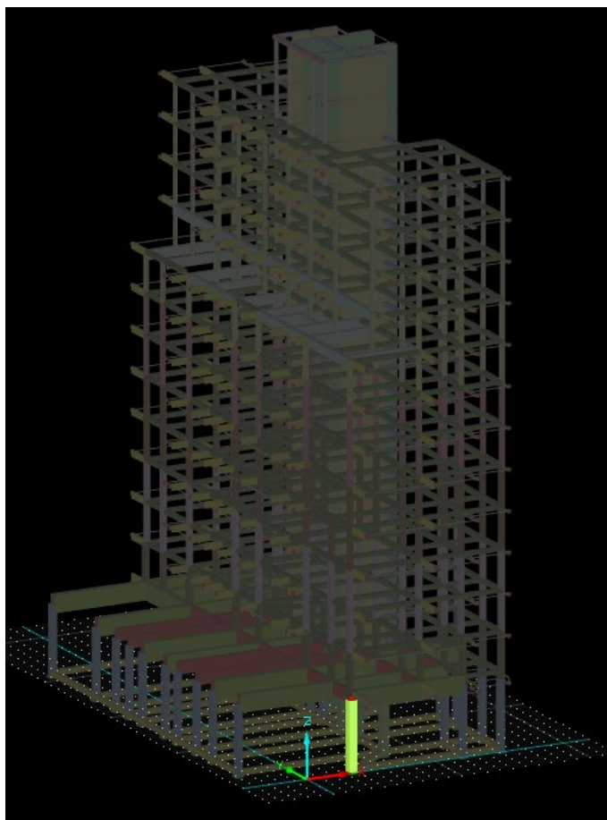
Diseño y calculo estructural: Fig. 42 Diagrama columna planta baja.
