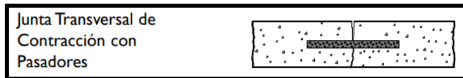
Figura VIII.7. Junta transversal de contracción con pasadores. (Fuente: Instituto del Cemento Portland Argentino).
