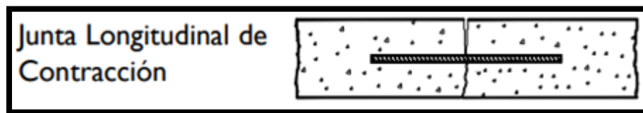
Figura VIII.9. Junta longitudinal de contracción con barra de unión. (Fuente: Instituto del Cemento Portland Argentino).
