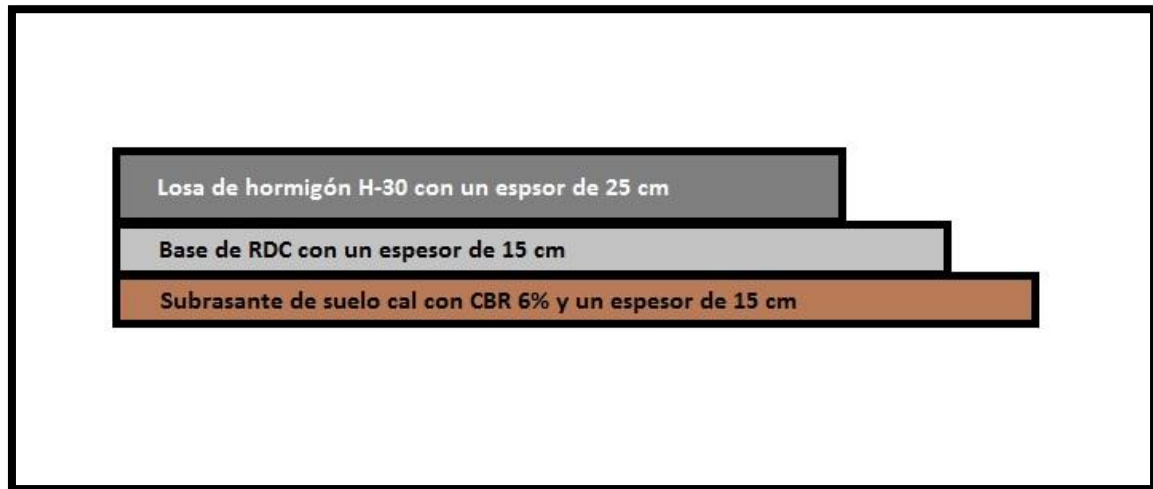
Figura VIII.6. Croquis del paquete estructural propuesto de la calzada vehicular. (Fuente: elaboración propia)
