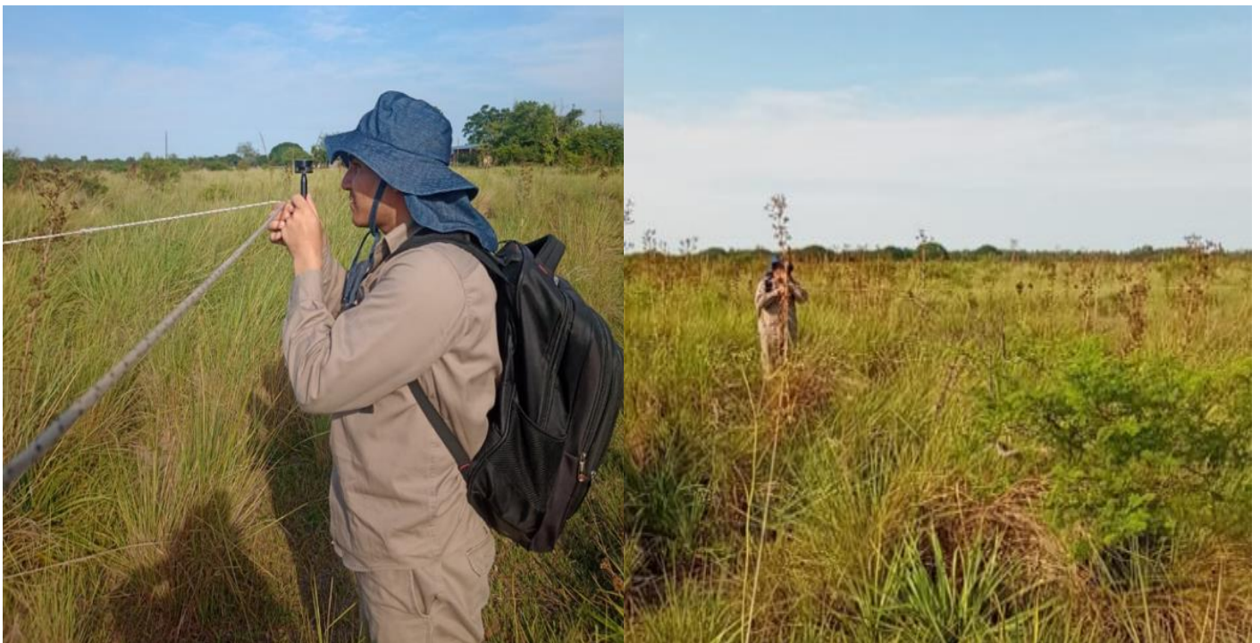
Imagen 1: Delimitación de parcelas de relevamiento de composición botánica. A) Uso de la escuadra óptica para delinear ángulos de 90°. B) Tensado de cuerda de 10 m para delimitar los extremos de la parcela cuadrada de 100 m 2 .
