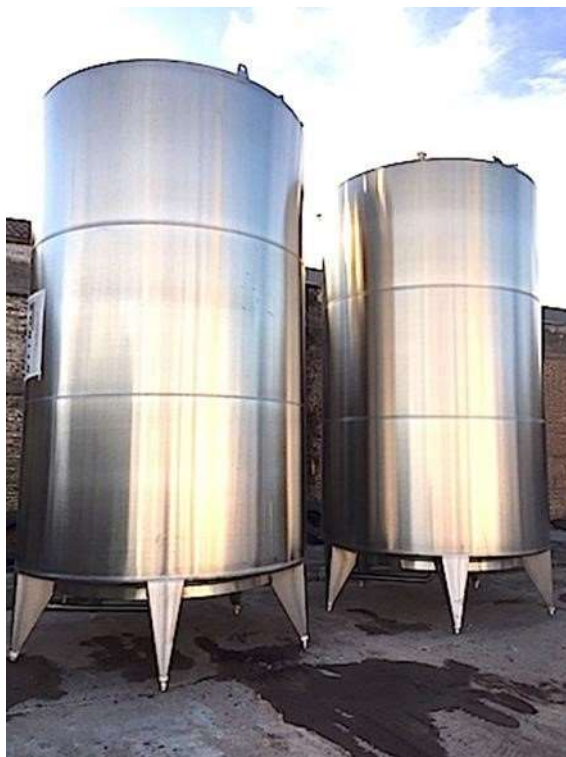
Ilustración 9: Tanques de etanol de Acero Inoxidable
