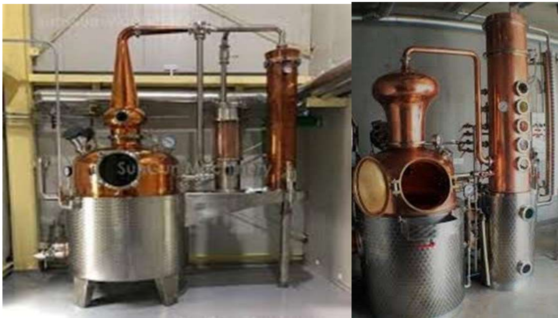
Ilustración 12: Alambique de Cobre y Acero Inoxidable
