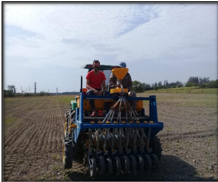
Figura 19: Sembradora acoplada al tractor.
