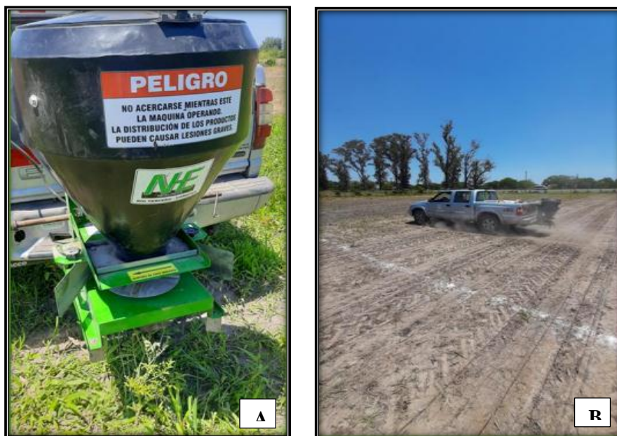
Figura 27. Fertilizadora (A), Aplicación de 4-18-40 (B)
