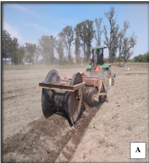
Figura 15. Rondero accionado por tractor (A), ancho del préstamo dejado por el arado el mismo (B).
