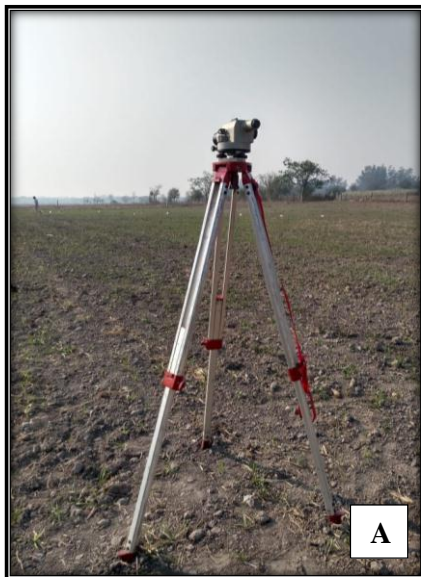
Figura 12. Nivel óptico Topcon (A y B).
