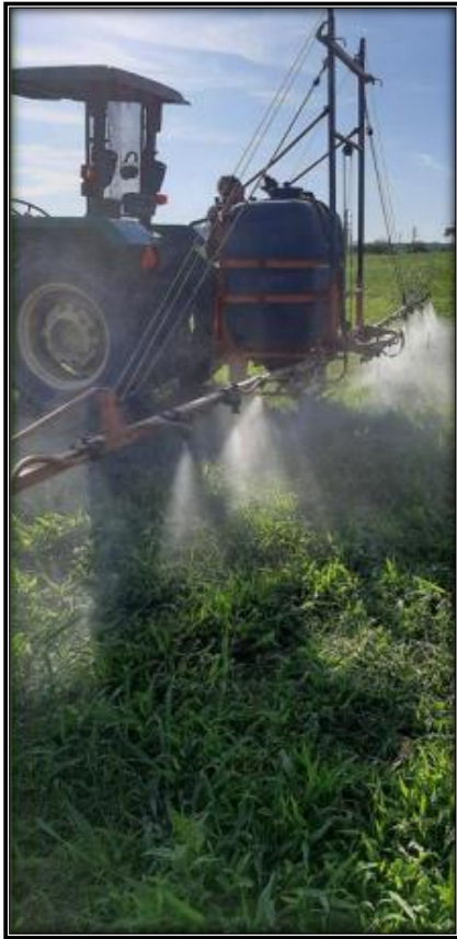
Figura 29. Verificación del correcto funcionamiento de la pulverizadora.
