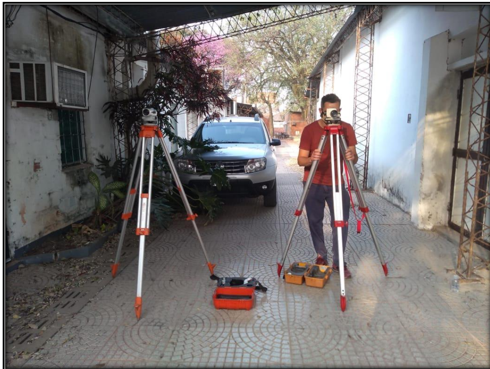
Figura 13. Calibración con nivel óptico testigo en la catedra de Mecanización Agrícola de la Facultad de Ciencias Agrarias.
