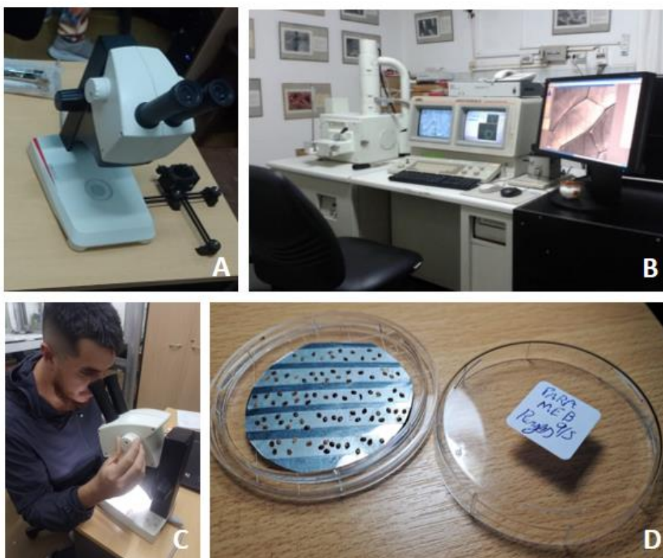
Fig. 8. Análisis y registro fotográfico de varroas. A. Microscopio estereoscópico marca LEICA modelo EZ4 con soporte para sostener dispositivo celular Samsung A33 con cámara fotográfica. B. Microscopio electrónico de barrido marca JEOL modelo 5800LV. C. Muestra de ácaros removidos por grooming .
