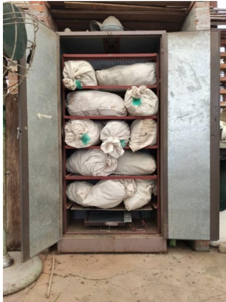
Figura 3. Detalle de estufa de secado de semillas de Stylosanthes previo a la trilla.
