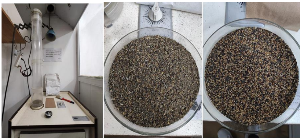
Figura 6: Detalle de soparador de semillas experimental. En las fotos de la derecha se puede distinguir las semillas de Stylosanthes al finalizar el soplado.
