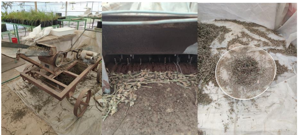
Figura 5: Detalle de trilla mecánica de semillas de Stylosanthes .
