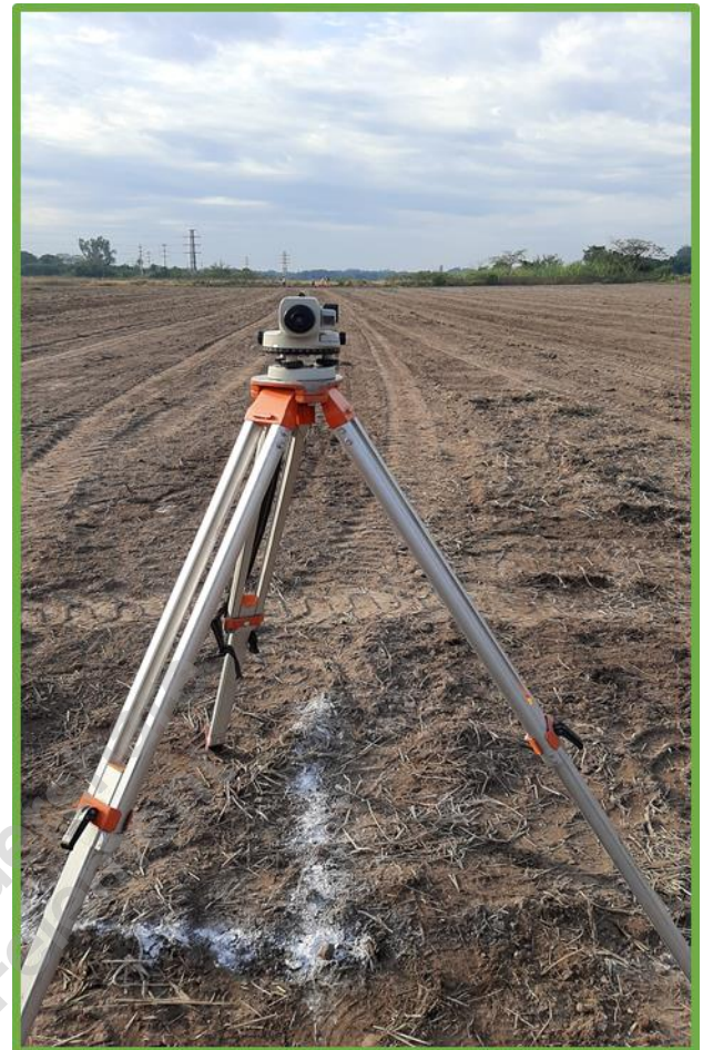
Figura 16: Nivel óptico Nikon 280377.
