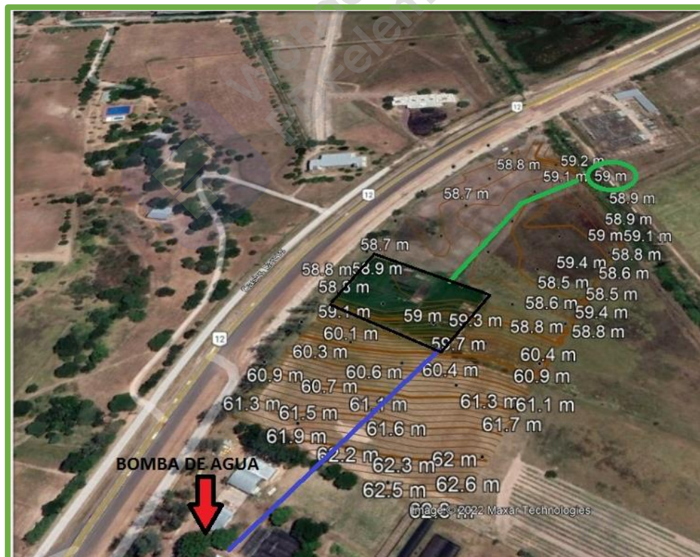
Figura 10: Imagen satelital de Google Earth, describiendo en línea azul canal de riego y en línea verde canal de desagüe al punto más bajo.
