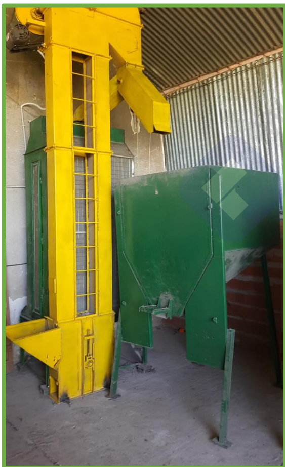
Figura 90: Secadora con la noria a canjilones y la tolva.
