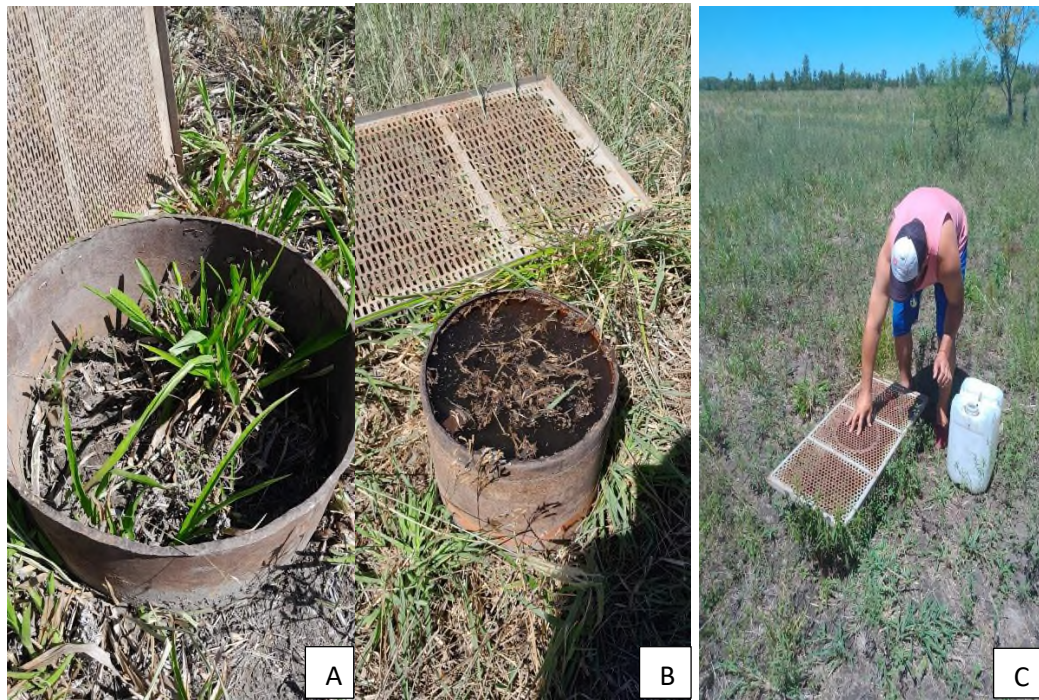
Figura 7. A: instalación del anillo de infiltración. B: llenado del anillo con agua. C: recarga y protección del anillo de infiltración.
