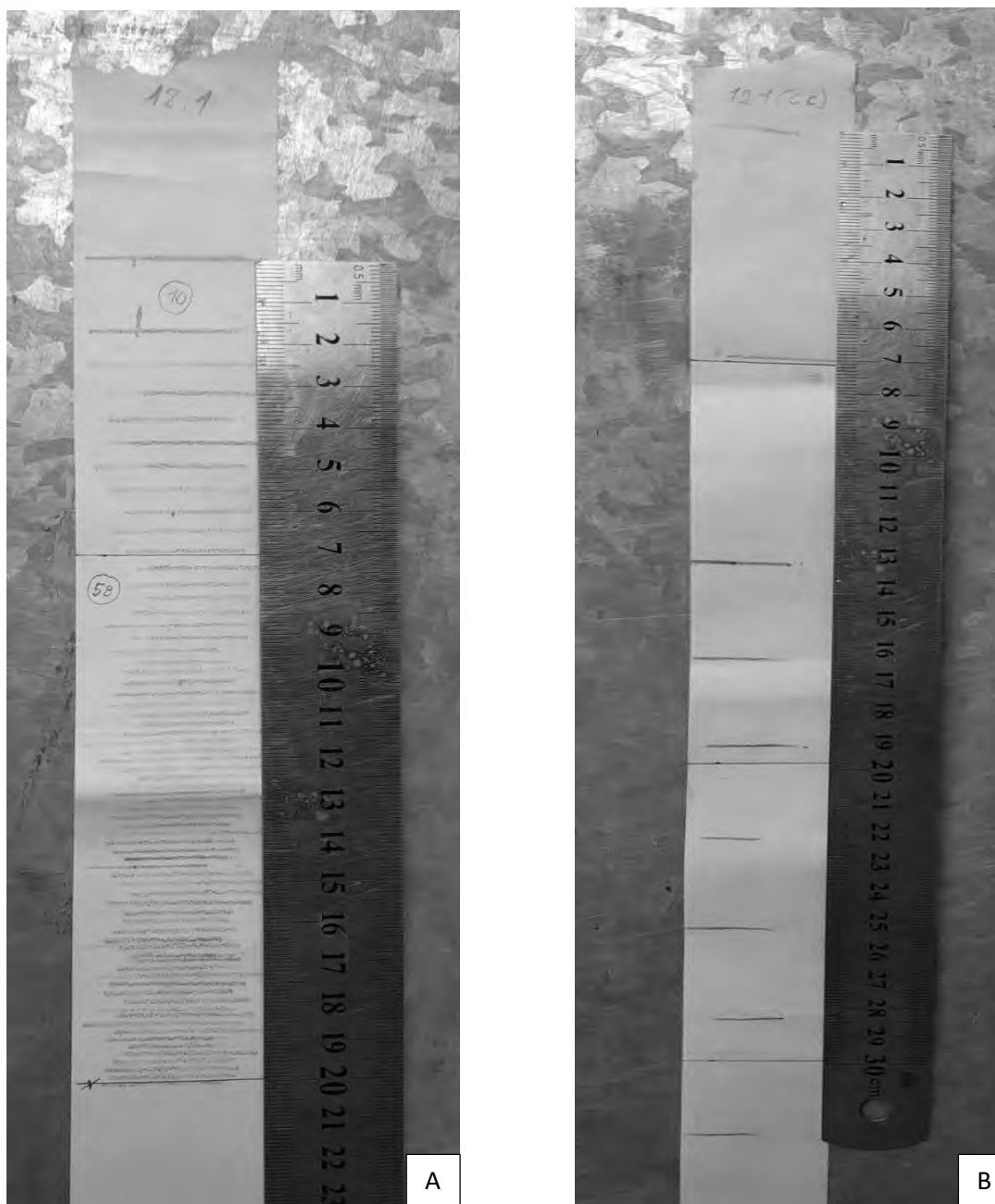
Figura 10. A: faja de RMP con suelo seco. B: con un suelo en condición de capacidad de campo.
