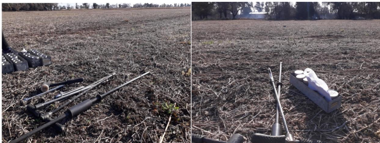
Figura 1 y 2: Penetrómetro de golpe tipo INTA Villegas (valores no publicados), junto a barreno para toma de muestras y en las bandejas metálicas los recipientes (latas).
