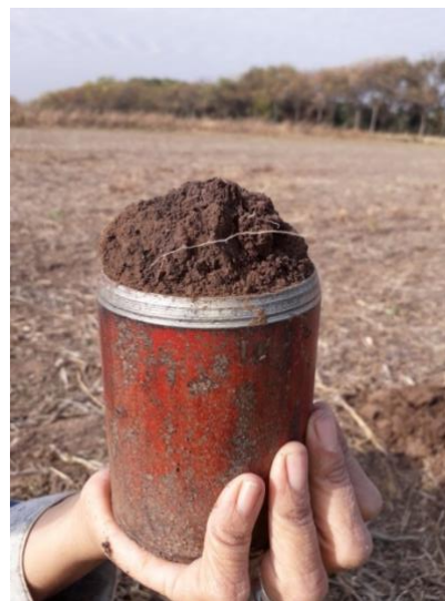
Figura 6 y 7: Cilindro de volumen conocido para determinar densidad aparente del suelo. 0-5 cm y 5-20 cm respectivamente
