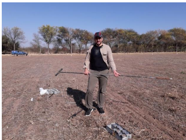
Figura 3: Barreno armado para tomas muestras hasta 2 metros de profundidad (valores no publicados)
