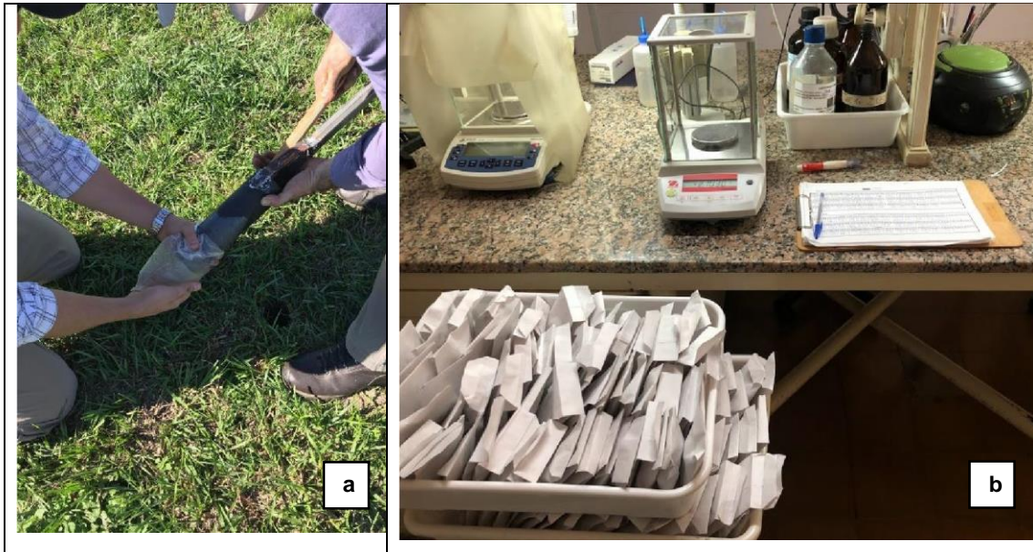
Figura 2: a) Muestreo de suelos para la determinación de biomasa de raíces y rizomas. b) Pesaje de muestras de raíces y rizomas por separado, posterior al secado en estufa, para determinar \text{g MS m}^{-2} .
