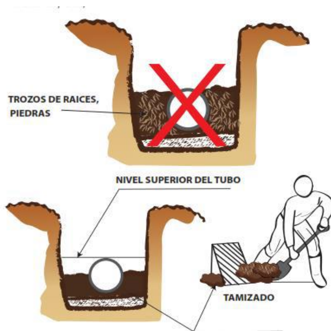
Figura 4.3. Cuidados en la selección del relleno inicial (Manual técnico Amanco. Año: 2014).
