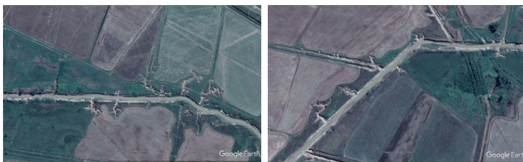
Imagen 2.9 y 2.10: Canalizaciones con fenómenos erosivos en la desembocadura sobre el arroyo Santa María - Fuente: Google Earth Pro.
