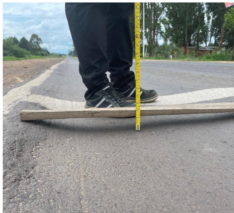
Fig. N°12. Ahuellamiento existente. Fuente: Foto tomada por nosotros.
