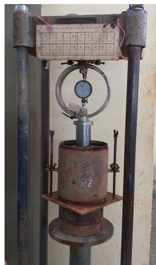
Fig. N° 25. Ejecución ensayo VSR. Fuente: Foto tomada por nosotros en el laboratorio de DPV.
