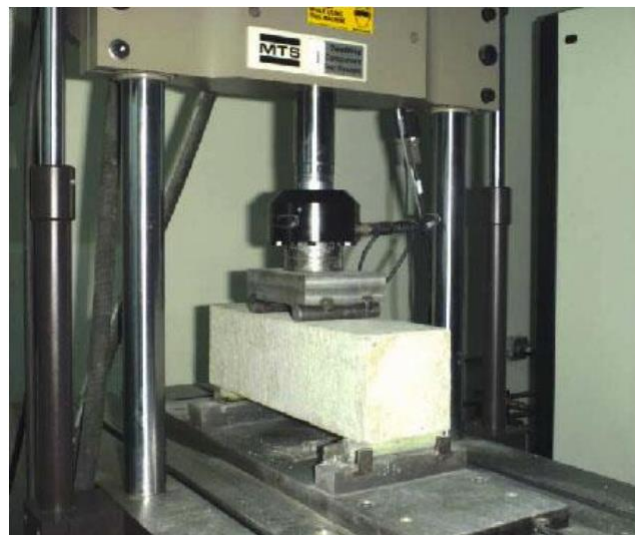
Fig. N°21. Ensayo de probeta prismática a flexión con carga en los tercios
