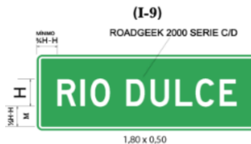
Figura N°66. Identificación de acc. geográfico y jurisdicción (Fuente: Manual de señalamiento vertical - DNV).
