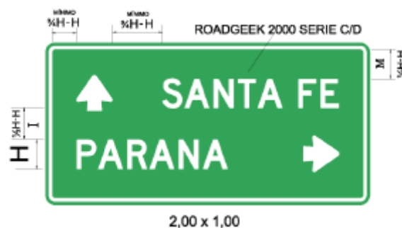
Figura N°65. Señales de orientación de distancia (Fuente: Manual de señalamiento vertical - DNV).
