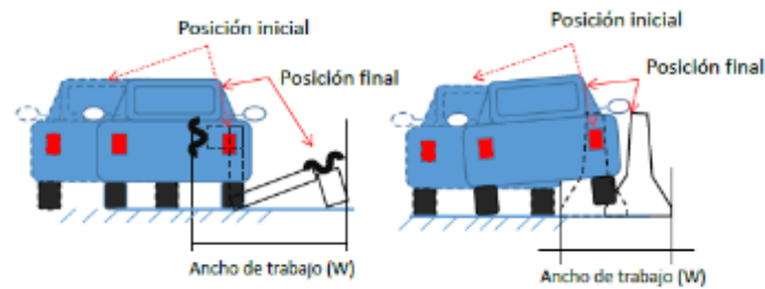
Figura N°77. Esquemas donde se identifican los anchos de trabajo (Fuente: Manual sistema de contención lateral - DNV).
