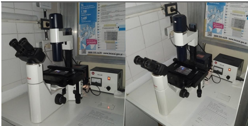
Fotografía 3: Se observa el microscopio de fluorescencia de luz invertida utilizado en el crossmatch por citotoxicidad dependiente del complemento. El mismo pertenece al Laboratorio de GENÉTICA MOLECULAR E HISTOCOMPATIBILIDAD del Hospital Dr. Julio C. Perrando, Resistencia, Chaco.
