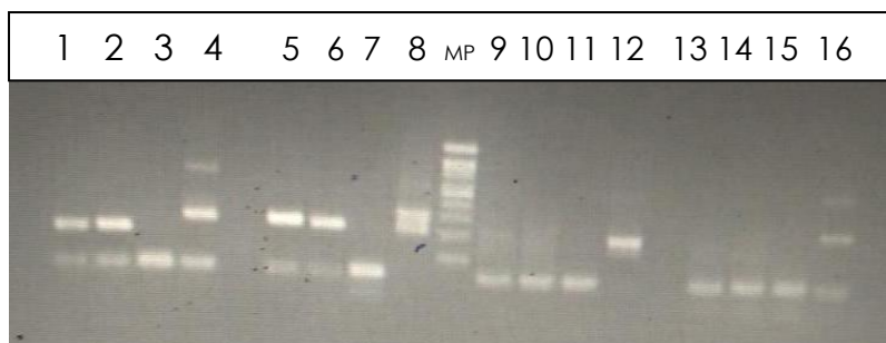
Fig. 18. Corrida electroforética en gel de agarosa revelada con GelRed bajo transiluminador UV. Se ve la corrida de 2 muestras y ambos controles (para los 4 grupos de genotipos mencionados). La muestra 1 se corrió
