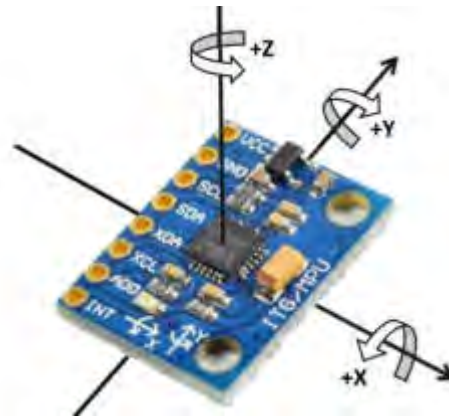
Figura 2: MPU6050 y los ejes de rotación el giroscopio
