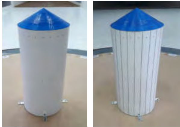
Figura 2 Modelo de silo aislado instrumentado con y sin rugosidad montado en la cámara de ensayos.
