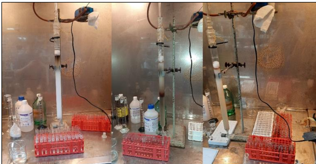
Figura 4: Esquema de la columna de fraccionamiento
