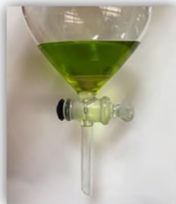
Figura 11. Separación de la fase acetónica (inferior) y la fase etérea (superior) que contiene los carotenos.
